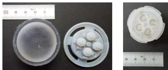
(a) 4個の半球の鋳造の鋳型 (b) 磁石を固定する穴
