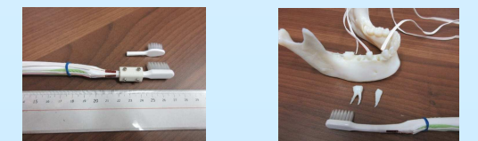
図16 毛先を付け替え歯ブラシのデザインの影響の検討。 図17 歯牙を抜き、高齢者のように脱落した歯列での検討。
