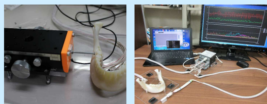
図9 ロードセルによる各歪みゲージごとのキャリブレーション。 図10 アクリル板に固定した歯牙モデル、計測系、それらを接続するケーブルからなる歪み計測システムとモニタリングの様子。
