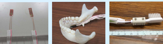
図6 有効長2mmと5mmの汎用箔歪みゲージ。 図7 歯列の裏側に汎用箔歪みゲージを設置した歯列モデル。 図8 正面と側面に箔歪みゲージを接着し、毛先部分を交換できるようにコネクタを設置した歯ブラシ。
