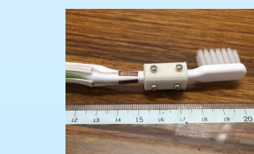
図4 正面と側面に歪みゲージを接着し、毛先部分交換用コネクタを設置した歯ブラシ。
