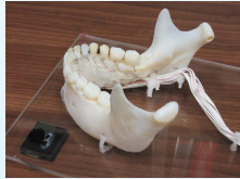
図3 7本の歯列の裏側歯根部に歪みゲージを設置した歯列モデル。
