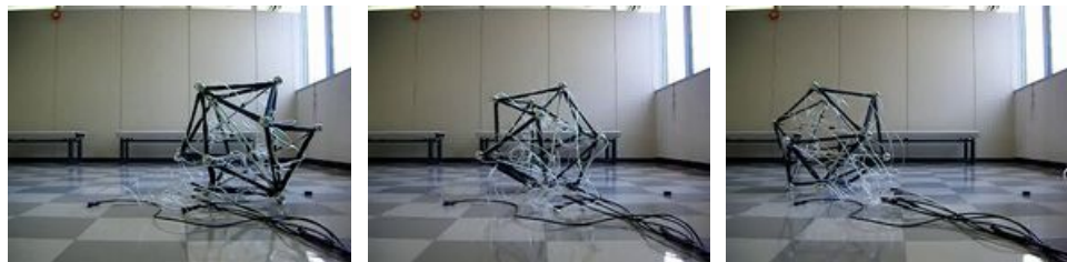
テンセグリティロボットの転がり移動
