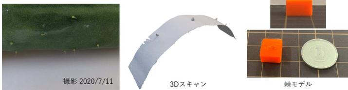
きゅうりの棘を模したモデルへグリッパを押し当てて耐久性能を評価 10000回の動作を確認
