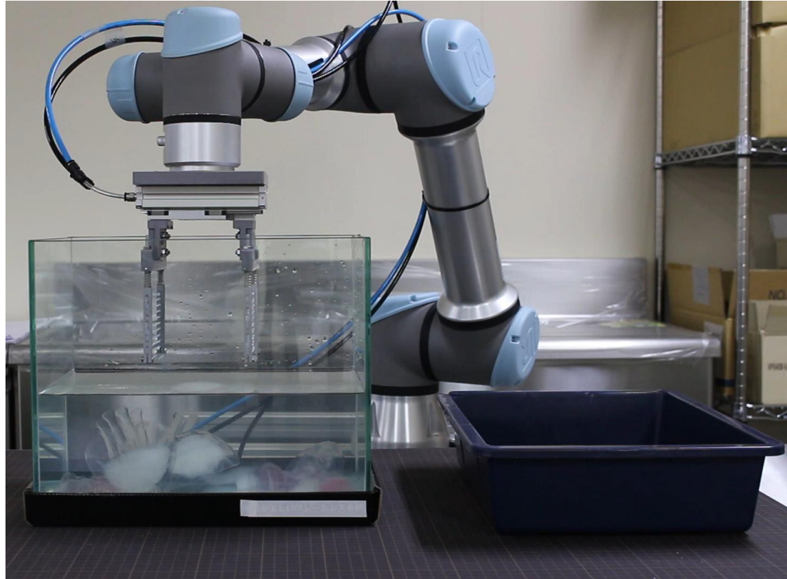
水中でのゲルクラゲ把持 Grasping the gel jellyfish from a water tank
