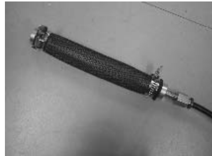
Fig. 2: Mckibben rubber actuator
