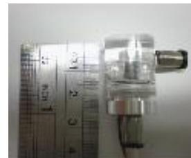
Fig.1 Miniaturized valve ( $\phi 15 \times 25\text{mm}$ )
