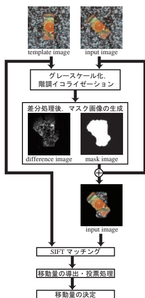
図 1 物体移動量計測アルゴリズムの流れ
