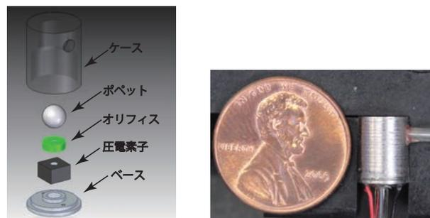
a. 無拘束ポペット弁の構成 b. 無拘束ポペット弁のプロトタイプ
