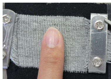
図 3 パイル構造を有する布地センサ
