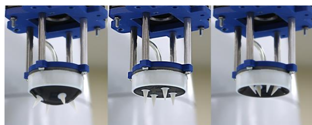
図1 柔軟膜の内圧によるグリップの構造変化
