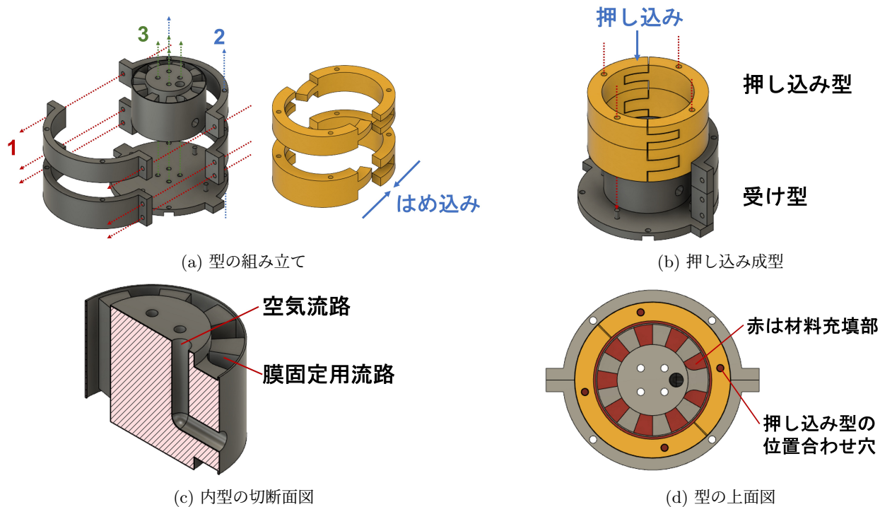
図 3: 複数材料の押し込み成型のための型
