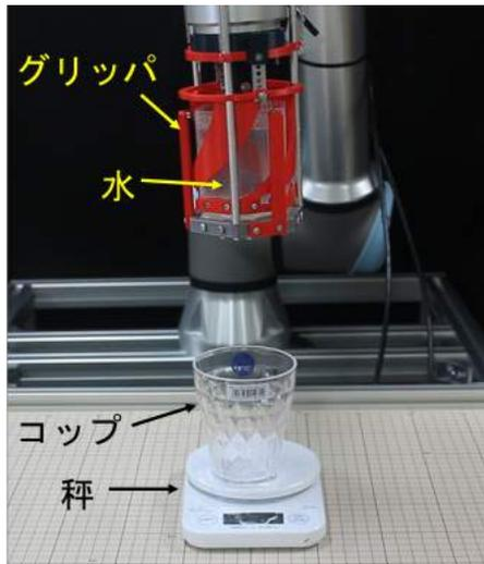
図 5: 液体の浸透実験環境
