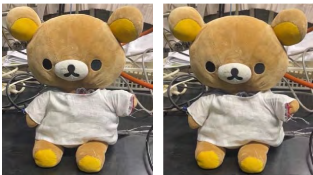
(a) 加圧前 (b) 加圧後 図11 大きさを変えた布状にした黒い人工筋を実装した水平運動
