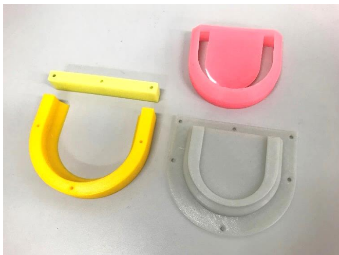
図3 粘膜模倣部品とシリコン成型のための型
